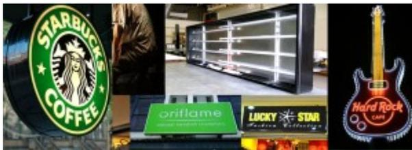
media ini menyala secara keseluruhan untuk menerangi visualisasi brand yang tertera. Dimana box didalamnya terdapat lampu neon yang dirangkai untuk pencahayaan dari dalam. Frame yang digunakan dapat berupa alumunium spray cat duco, alumunium profil ataupun stainless steel. Biasanya berbentuk Kotak dan didalamnya berisi Lampu, dengan cover dari bahan vinyl Backlight atau Colybrate.
